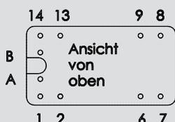
Der PIN A und B wird nur bei der Ausführung 3865 1251 ... verwendet.
