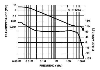
FIGURE 57. TRANSIMPEDENCE vs FREQUENCY
