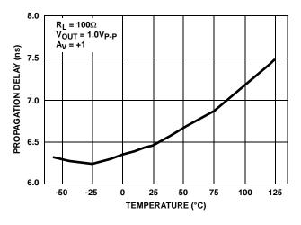
FIGURE 47. PROPAGATION DELAY vs TEMPERATURE
