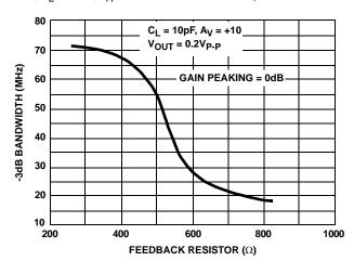
FIGURE 26. BANDWIDTH vs FEEDBACK RESISTANCE
