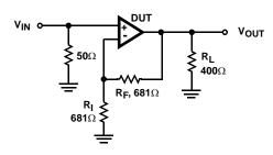
FIGURE 3. LARGE SIGNAL PULSE RESPONSE CIRCUIT
