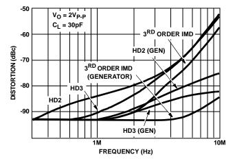
FIGURE 35. DISTORTION vs FREQUENCY
