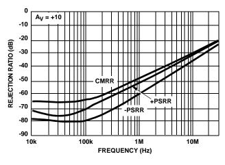
FIGURE 28. REJECTION RATIOS vs FREQUENCY
