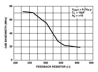
FIGURE 45. BANDWIDTH vs FEEDBACK RESISTANCE
